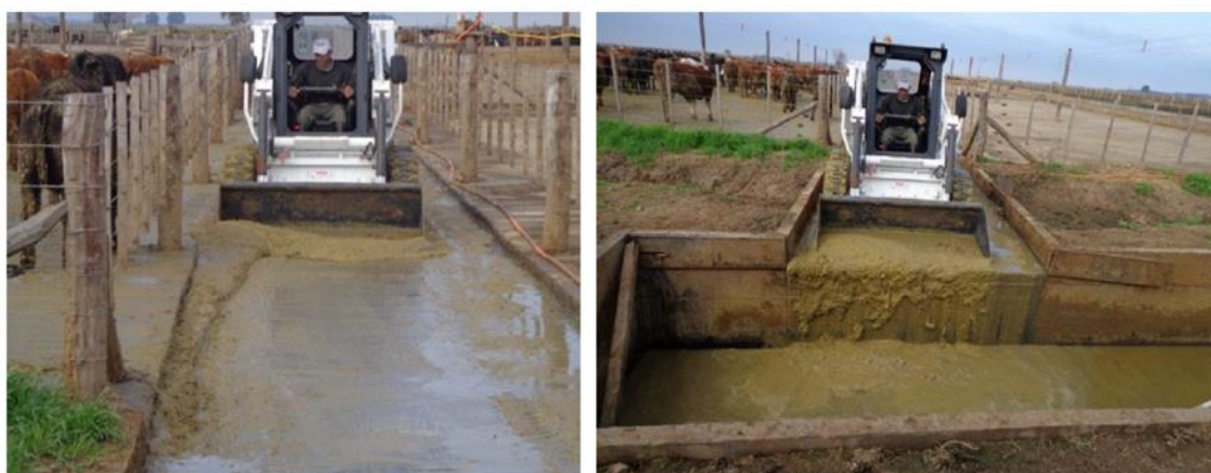
Figura 4. Operación de arrastre de sustrato orgánico hacia cámara de pretratamiento – Fuente [8]
