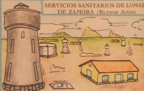
25 pozos semisurgentes con 6 Diesel bombas y 19 electrobombas. 4 depósitos enterrados y 2 elevados. 245.000 metros de cañerías y 21.500 conexiones.
