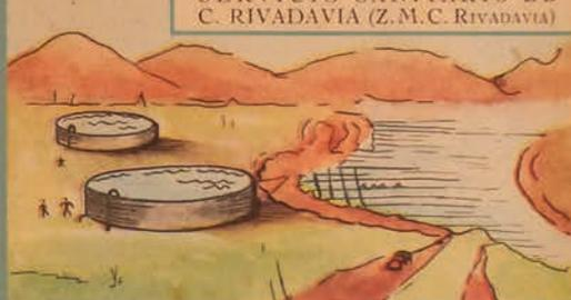
Captación de Los Manantiales y Rosales. Dos tanques australianos. El Estado instaló 11.000 metros de cañerías y 1.100 conexiones.
