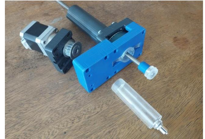
El dispositivo es del tipo de extrusión directa por pistón mecánico (Ruscitti et al., 2020): un motor paso a paso -sincronizado electrónicamente con los movimientos de la impresora – controla un tornillo de transmisión, que empuja el émbolo de una jeringa que contiene la pasta a extruir a través de su pico o boquilla.
